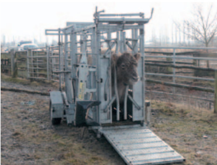
Mobiele vanginstallatie met vanggang en behandelbox in metaal, aansluitend op een houten kraal. (Heidebos, Wachtebeke-Moerbeke)
